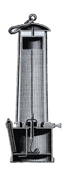
толщина, размер ячеек и теплоёмкость материала которой были подобраны таким образом, чтобы при воспламенении горючего газа, попадающего внутрь сетки, горение не распространялось наружу и не вызывало взрыв газовоздушной смеси.
